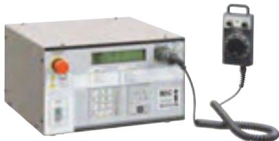
Такой генератор импульсов может обеспечить дискретность поворота стола 0.1°, 0.01° и 0.001° и без труда регулирует патроны. Один генератор импульсов может работать с MAC mini iH2/iHT, управляя вращением шпинделя.
